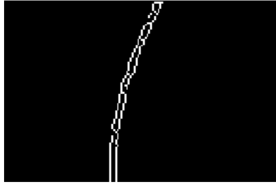
Figure V.10. Application de l'opération de détection de contours à l'image corrigée, apparition de la trajectoire du robot.
