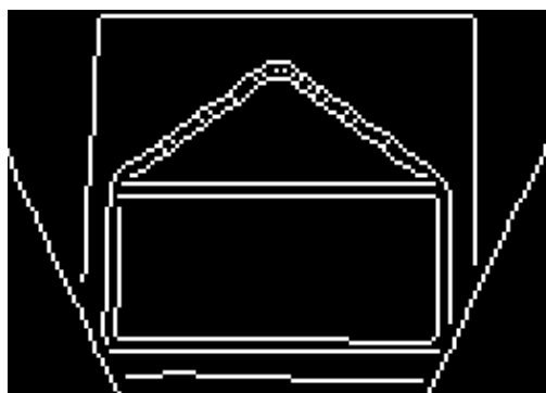
Figure V.6. Détection de contours sur l'image redressée
