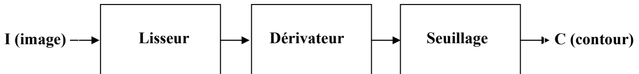
Figure III.1. Schéma de principe d'une chaîne de détection de contours
