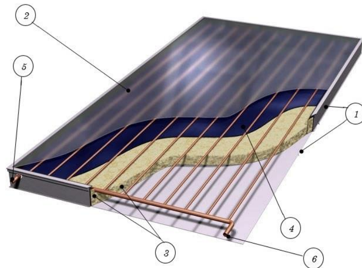
Figure 2.8 Structure du capteur plan (1) Boîtier, (2) Couverture transparente, (3) Isolant thermique, (4) Absorbeur, (5) Entrée fluide caloporteur, (6) Sortie fluide caloporteur. [44]
