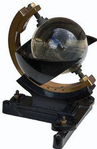
Figure 1.11 L'héliographe de Campbell-Stockes [15]
