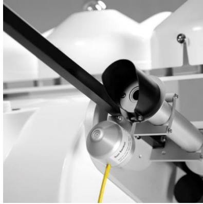
Figure 1.13 Mesure du rayonnement Directe avec un pyréliomètre [43]
