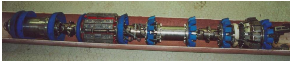
Fig.1.5 : Piston instrumenté pour l'inspection des gazoducs [2]
