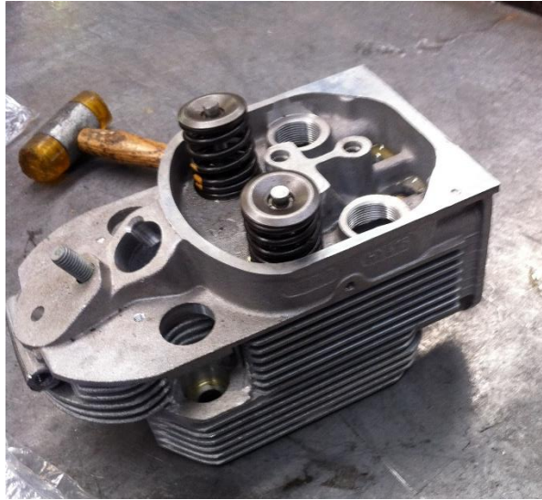
Figure II.5 Culasse individuelle avec soupapes intégrées
