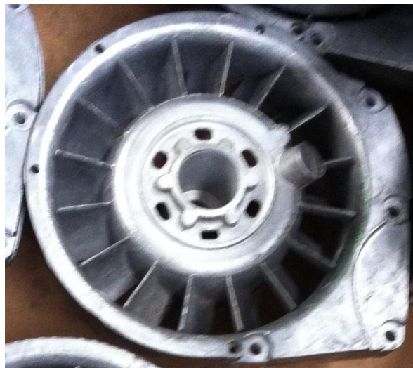
Figure II.9 Turbine de refroidissement
