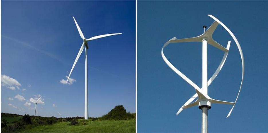
**Figure 1.2:** éolienne à axe vertical (à droite) et à axe horizontal (à gauche)
