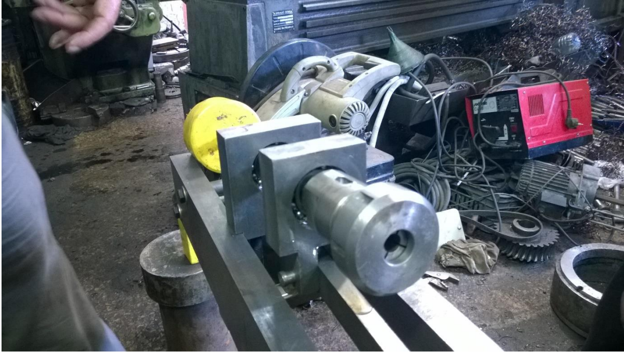
Fourreau coté fixe + Palier mobile + Palier fixe + Masse d'équilibre 3.30 Kg
