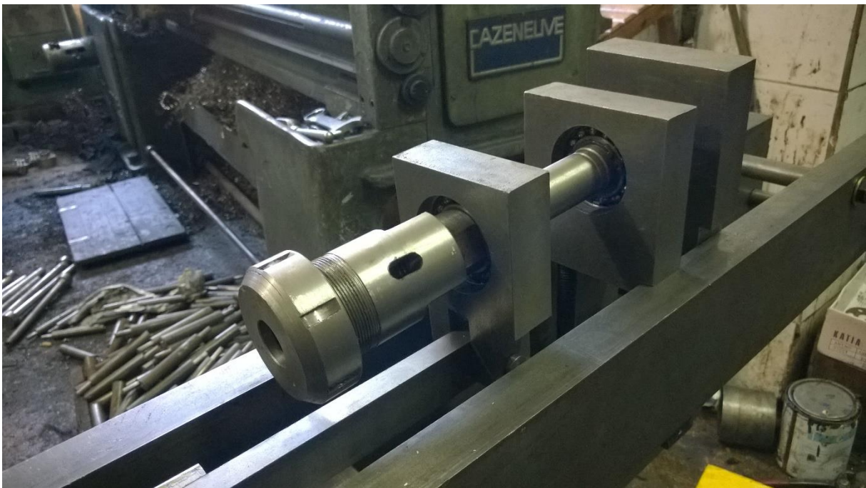
Fourreau coté moteur + Porte moteur + Palier mobile + Palier fixe
