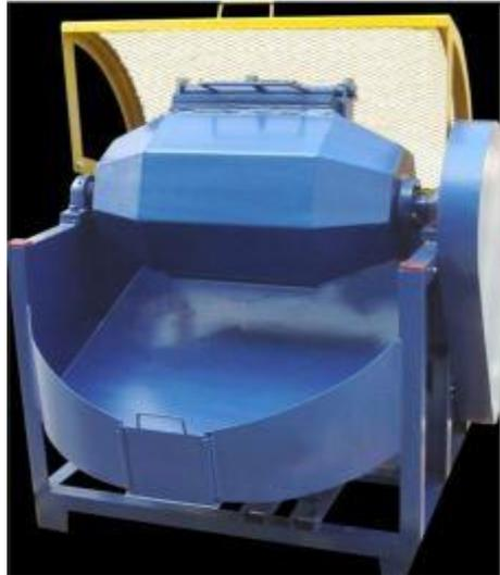
Fig. 2.11 – Tonneau rotatif. [INT1].
