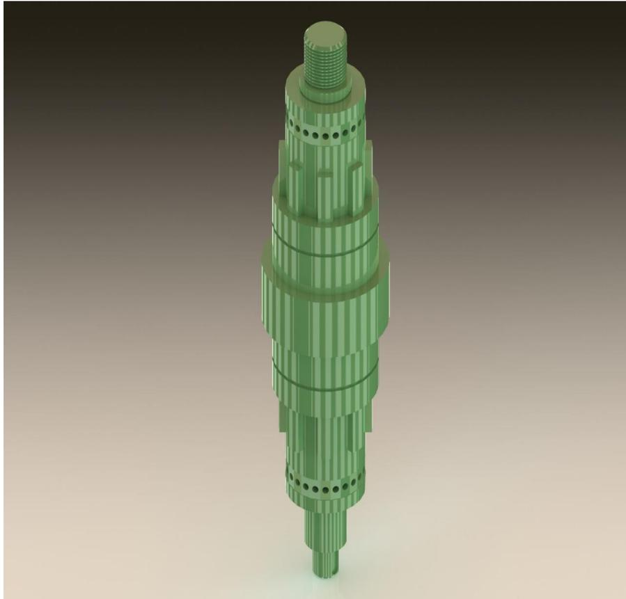
Fig. 3.8 – L'arbre du vibreur conçu sous Solidworks.
