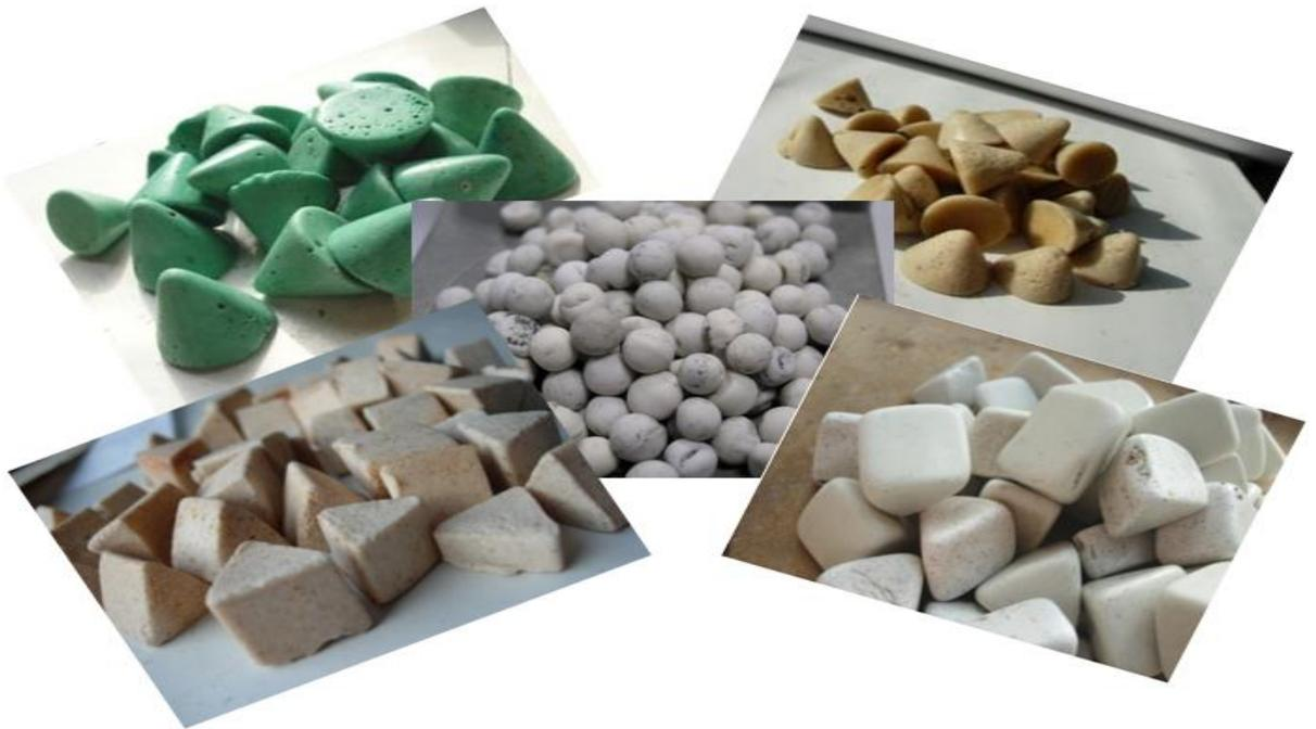
Fig. 2.16 – Médias (abrasifs sous plusieurs formes, tailles et matériaux).
