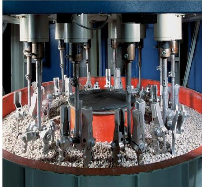
Fig. 2.9 – Machine multibroche de type Smuritropie. [INT3].
