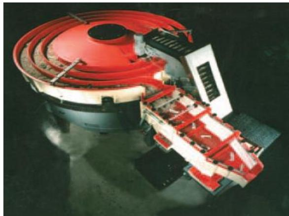
Fig. 2.5 – Un vibreur circulaire spirale de type Rotomatic. [INT3].
