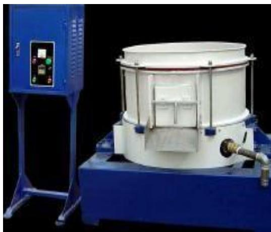
Fig. 2.12 – Centrifugeuse à fond tournant. [INT1].
