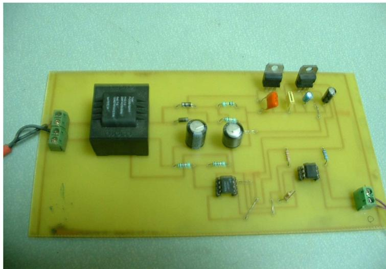
**Figure IV. 22. Maquette du détecteur de passage par zéro.**
