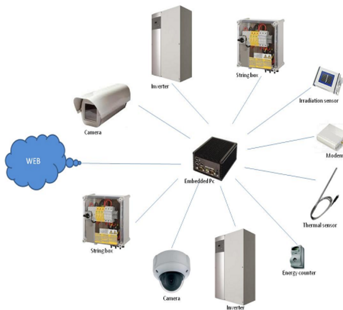
FIGURE I.17 – Le système intégré de supervision
