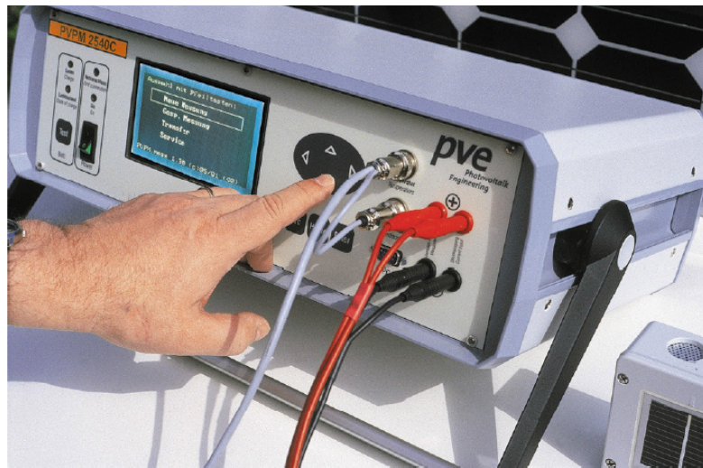
FIGURE III.7 – PVPM :un appareil pour mesurer la caractéristique I-V
