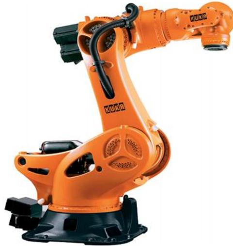
**Figure I.2:** Robots anthropomorphiques sériel à six articulations KR1000 1300 TITAN PA de KUKA
