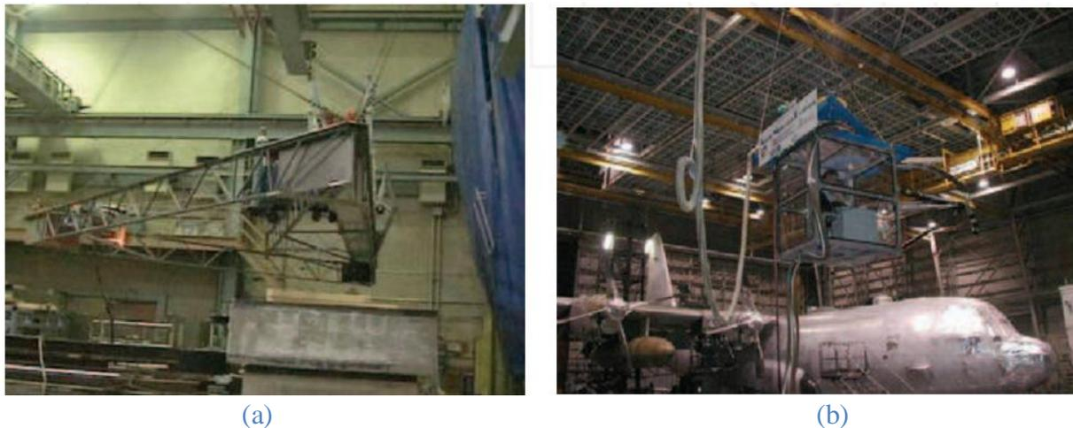
**Figure I.11:** (a) Le NIST Flying Carpet -. Une plate-forme pour l'accès des navires en cale sèche (b) le NIST Projet d'entretien d'aéronefs (AMP) - une plate-forme d'accès d'avion dans des hangars [Alan2008]
