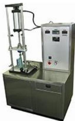
Figure 6 Banc d'essai de Staley Co. pour AEMs
