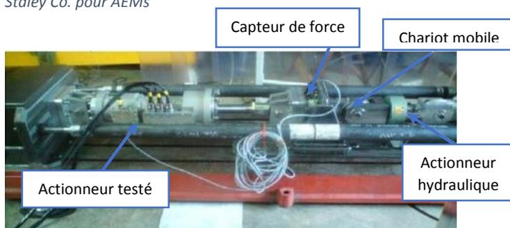
Figure 8 Banc d'essai de SABCA pour AEMs
