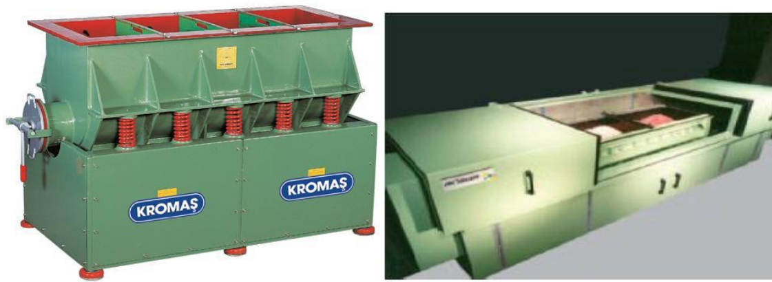
Figure. 3. 9. Deux types de vibrateurs linéaires.
