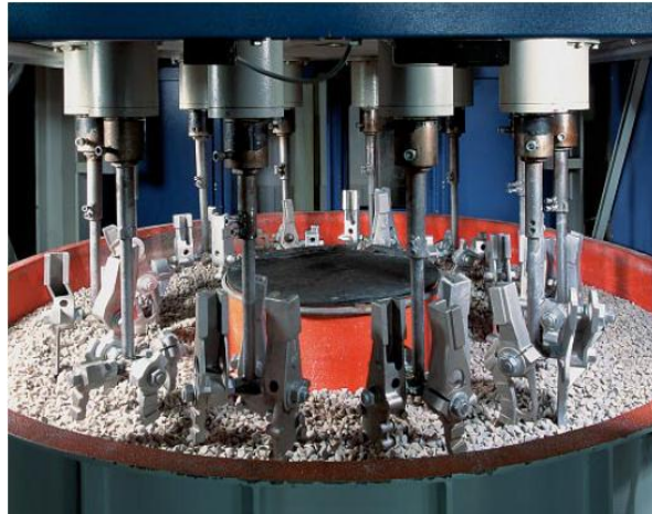
Figure. 3. 11. Machines multibroche type Smuritropie.
