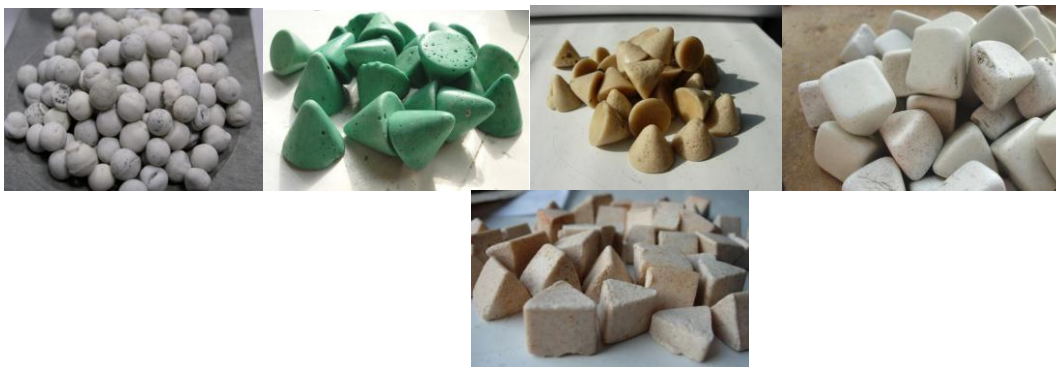
Figure 3. 12. Différents types d'abrasifs (Cône, Bille et prisme)
