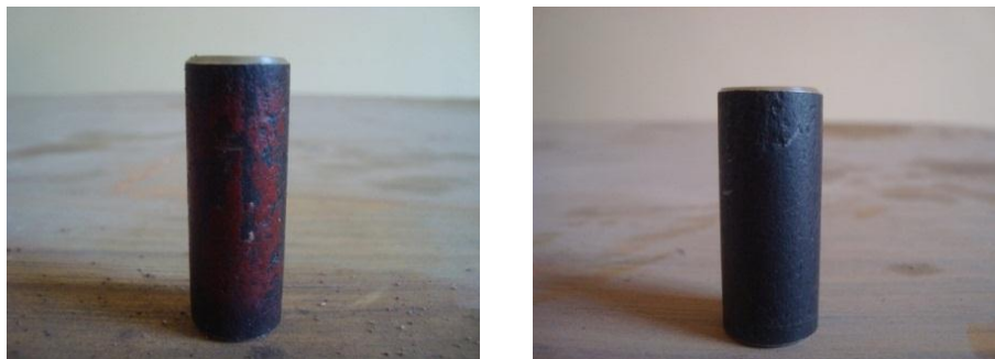
Figure 4.11:Exemple d'enlèvement de la bavure
