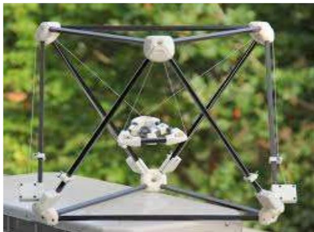
**Figure I-4** : exemple d'un robot parallèle à câbles [ABD.2001]
