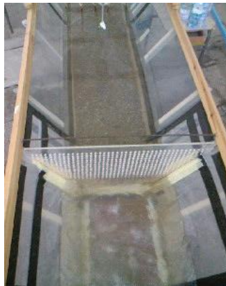
Figure III.5 : Influence des plaques en nids d'abeilles sur la diminution des tourbillons engendrés par la pression de l'injection d'eau.
