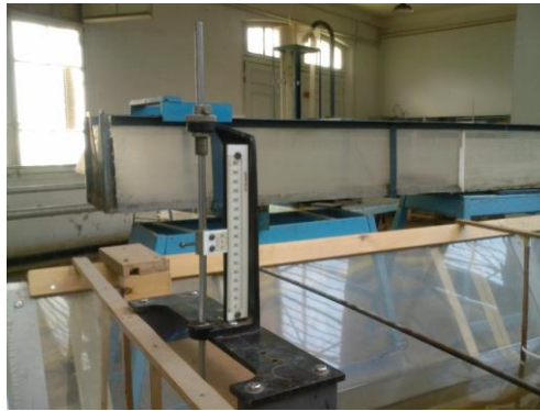
Figure III.13 : Limmimètre de mesure de la hauteur d'eau
