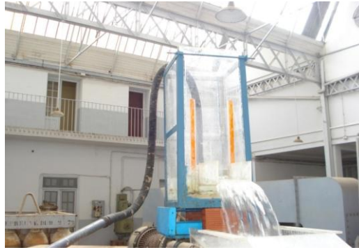
Figure III.1: Réservoir d'alimentation (LRS eau. ENP)
