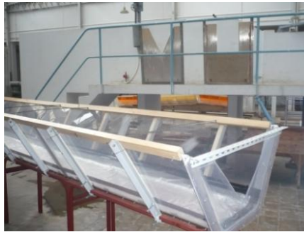
Figure III.4 : Support en acier qui permet de modifier les fruits des talus du canal
