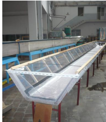
Figure III.8 : Photographie du canal trapézoïdale ( LRS eau. ENP )
