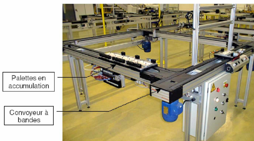
Figure 1.11 : Exemple d'entraînement par palette libres
