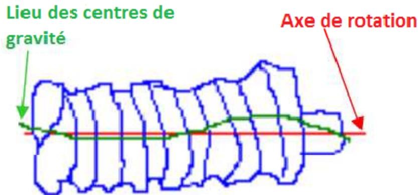
Figure I.10 : Tolérances d'usinage sur un rotor.
