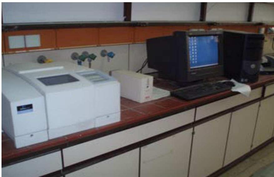
**Figure 4 : Spectromètre infrarouge à transformé de Fourier relié à un ordinateur pour le traitement et analyse des données.**
