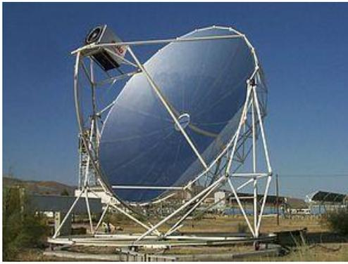
*Figure I.3 : Miroir parabolique concentrateur.*
