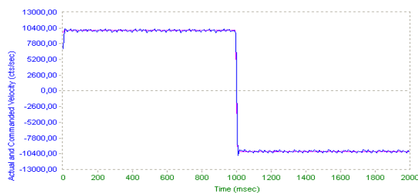
Figure 5.4 : Réponse en vitesse à une rampe
