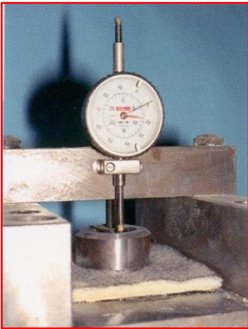
Mesure de l'épaisseur sous \sigma_v .
