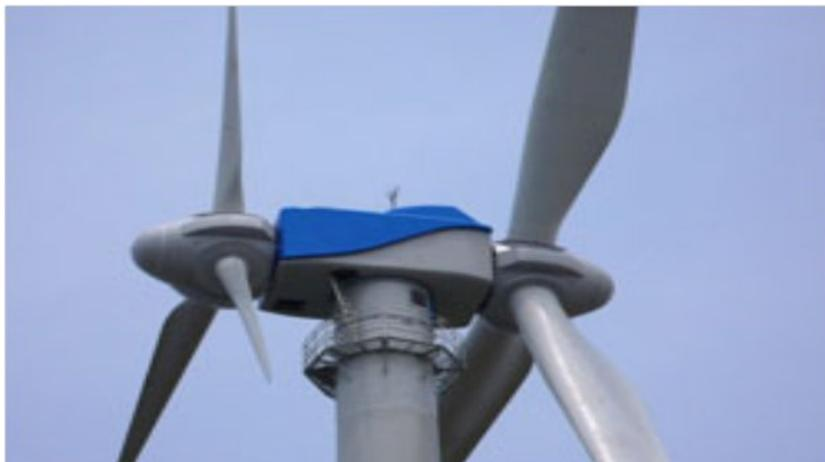
FIGURE 1.15 – éolienne à double rotor [11]
