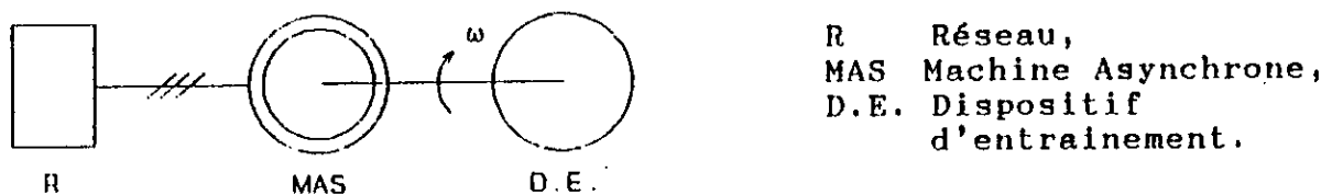
Figure 1.1 Génératrice asynchrone couplée au réseau.
