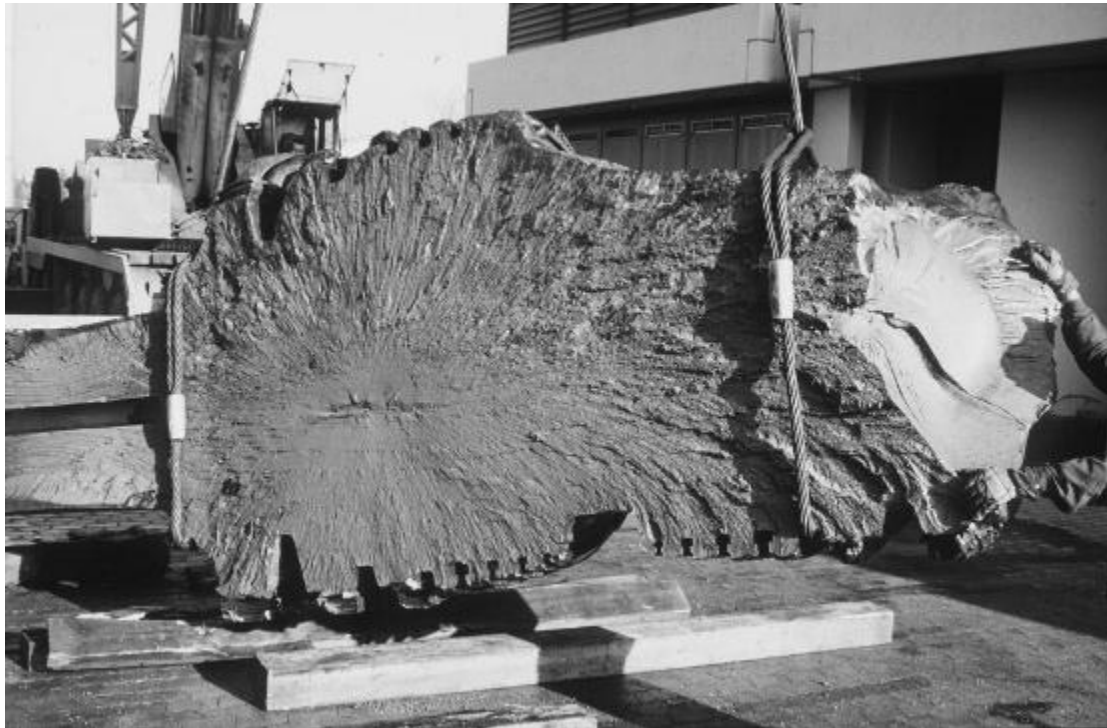
Figure I.2. Défaillance de fatigue d'un axe de turbine à vapeur fait en 28 NiCrMoV85 . Le fragment montré a une masse d'environ 24 t . La fissure a commencée à un défaut matériel dans l'axe [8].
