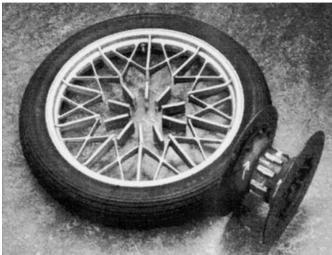
(a) Roue avant, transitoires cassées, pièce d'axe avec des freins à tambour.
