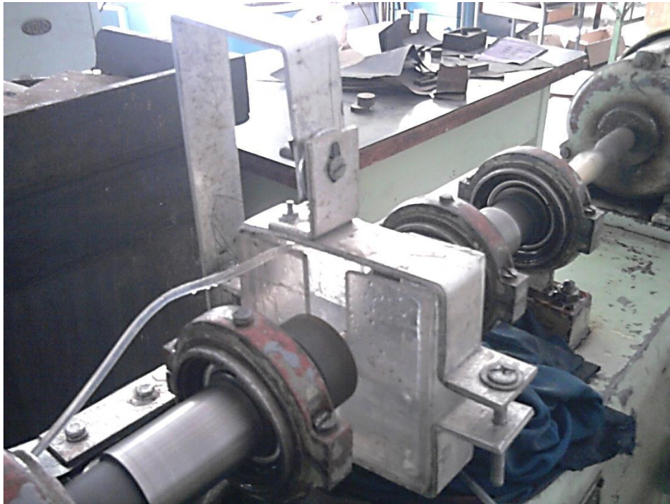
Photo IV.6. Cellule de corrosion et système de fixation.
