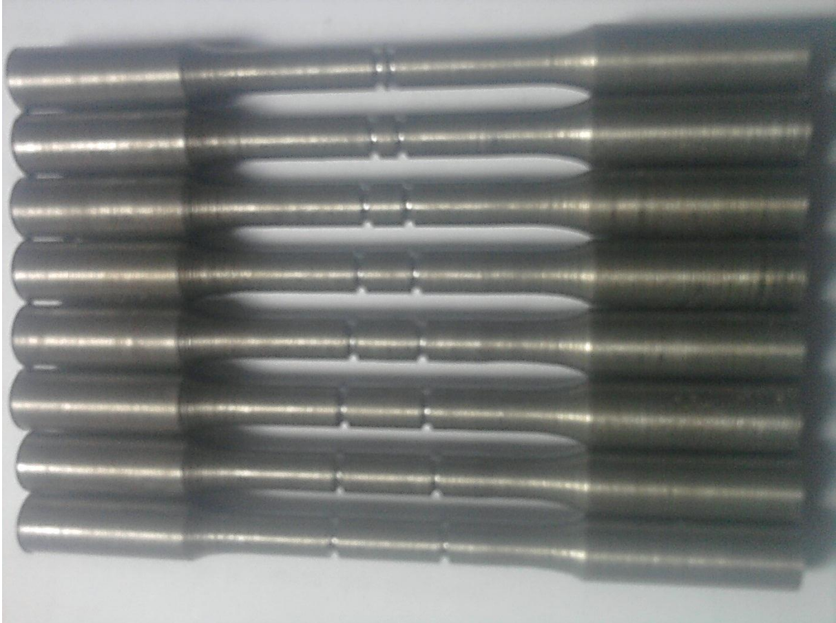
Photo IV.3. Variation de la distance X dans les éprouvettes usinées.
