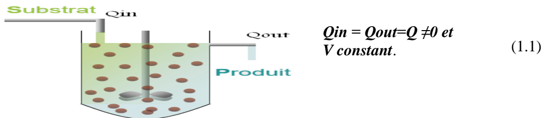
Figure (1.2) : réacteur en mode continu
