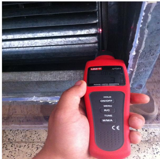
FIGURE 3.1: Mesurage de la vitesse de rotation
