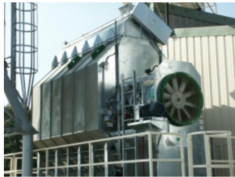
FIGURE 1.2: Ventilateurs utilisés dans différentes applications : a) refroidissement de carte graphique, b) refroidissement de voiture, c) séchage d'aliments dans l'industrie agricole [9].
