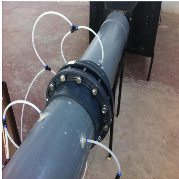
FIGURE 2.4: Raccordement des prises de pression dans le banc d'essais
