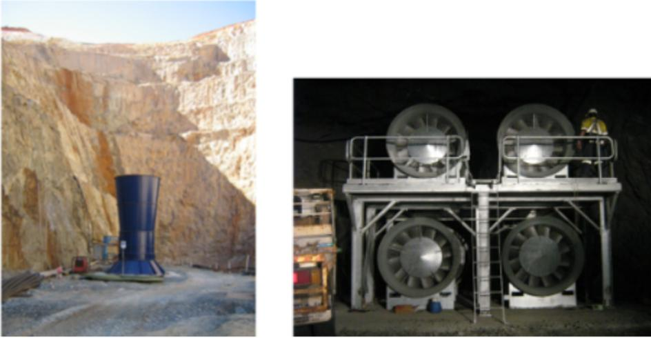
FIGURE 1.1: Ventilateurs utilisés dans les ouvrages souterrains [9]
