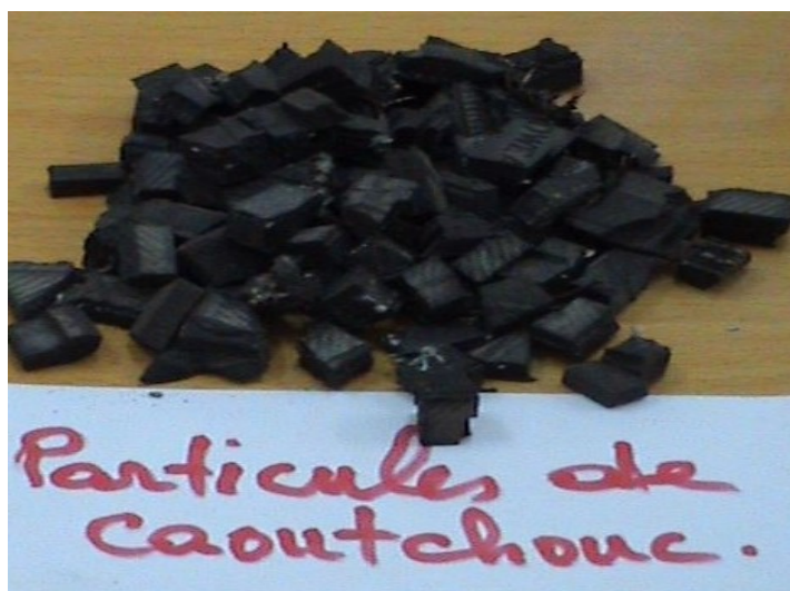
Fig. 3.3. Particules en caoutchouc coupées manuellement.
