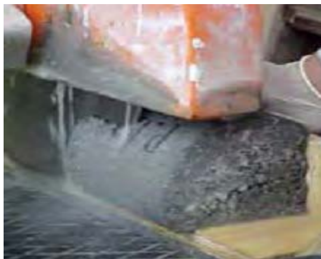
Fig. 1.18. Préparation d'une éprouvette prismatique à partir d'une carotte (Harrington et al., 2010).
