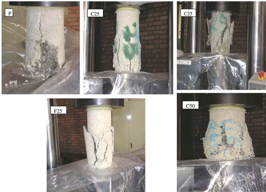
Fig. 2.10. Types de rupture (Khaloo et al., 2008)
