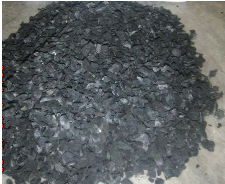
Fig .6.1. Caoutchouc traité par la soude.
