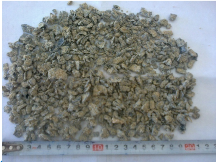
Fig. 6.7. Particules de caoutchouc après traitement.
