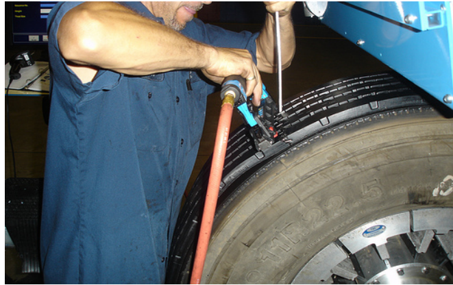
Fig. 2.2. Pose d'une bande de roulement sur un pneu usagé. Source : http://www.sustainablecitiesnet.com/tag/waste/page/2/
