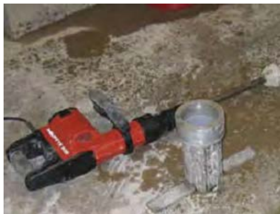
Fig. 1.12. Marteau vibrant (Harrington et al., 2010).
