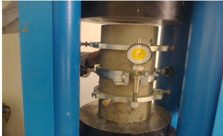
Fig. 5.17. Dispositif de mesure du module d'élasticité.
