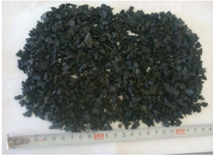
Fig .3. 4. Particules en caoutchouc utilisées dans le programme expérimental.
