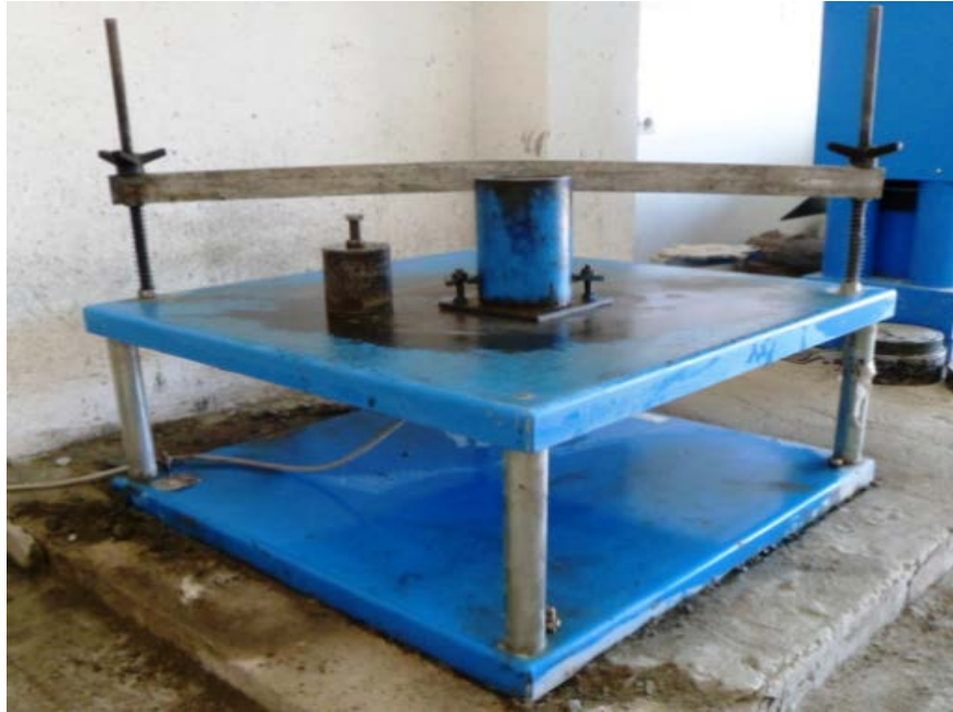
Fig. 3.10. Table vibrante, surcharge de compactage et système de fixation de l'ensemble.
