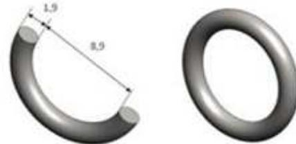
Figure 49 : dimensions du joint torique utilisé.
