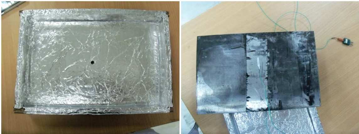
FIG 4-10 : Perçage des caissons et collage des thermocouples
