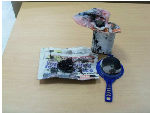
FIG 4-7 : Impuretés initialement présente dans la peinture sélective
