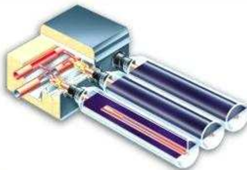
FIG 2-3 : Capteur à tubes sous vide à circulation directe
