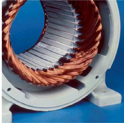
Fig.2.1.Le stator de la machine asynchrone
