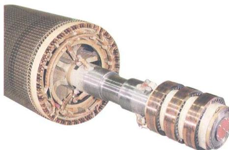
Fig.2.2.Le rotor bobiné
