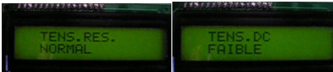
Figure 4-19 : Indication de l'état des paramètres impliqués à la connexion au réseau
