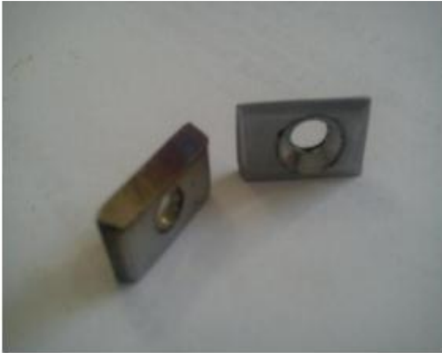
Figure V. 8: Mécanisme pour la fixation de l'extensomètre
