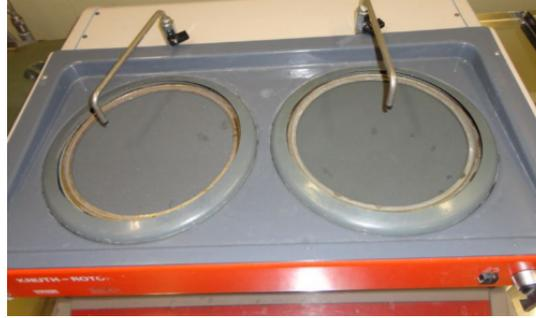
FIGURE 3.5 – Appareil de polissage
