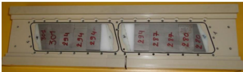
FIGURE 3.14 – Répartition des plaques de matériaux magnéto-caloriques dans le régénérateur
