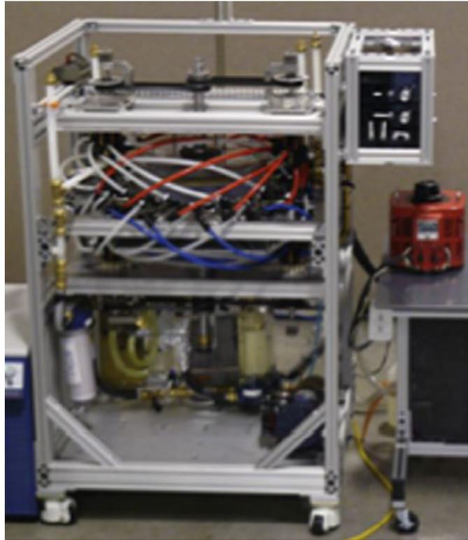
FIGURE 1.7 – Démonstrateur de RM développé récemment par Astronautics (Jacobs et al. 2014)
