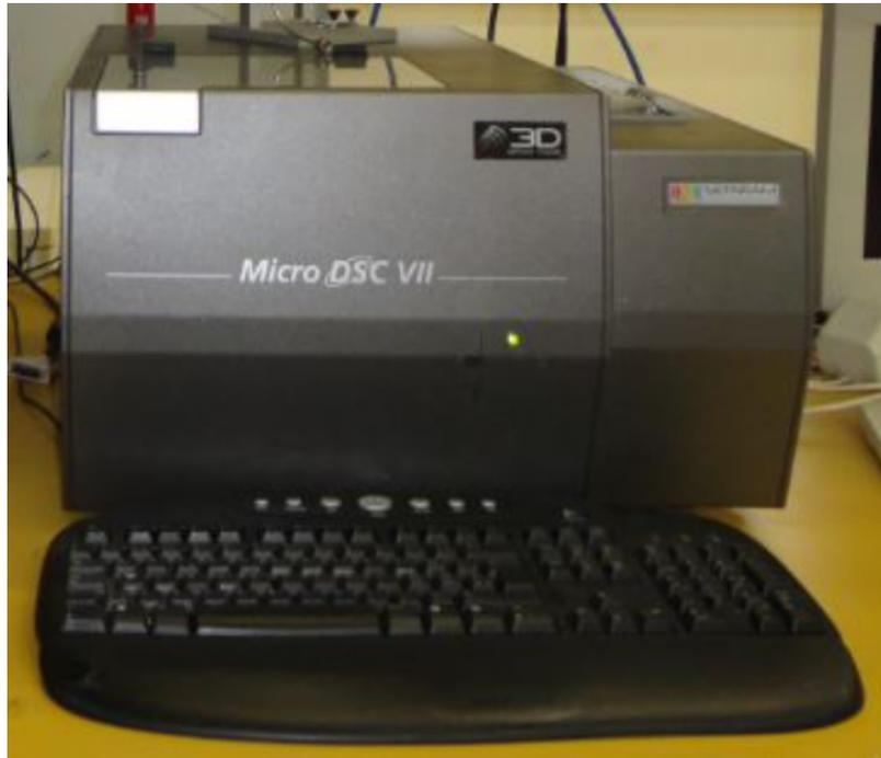
FIGURE 3.9 – micro DSC : Dispositif de mesure de la chaleur spécifique
