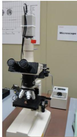
FIGURE 3.6 – Microscope utilisé pour visualiser les échantillons après l'attaque par des réactifs chimiques
