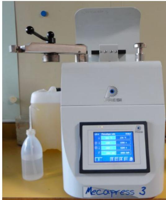
FIGURE 3.3 – Dispositif de l'enrobage
