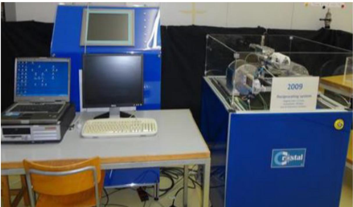
FIGURE 3.13 – Dispositif de réfrigération magnétique construit au sein de HE-SO
