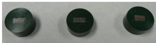
FIGURE 3.4 – Les échantillons magnétocaloriques après l'enrobage
