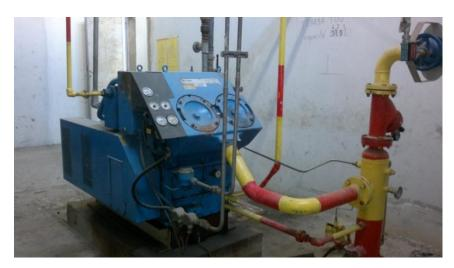
Fig. 5.3. Compresseur du gaz d'hydrogène de l'unité de production d'hydrogène.
