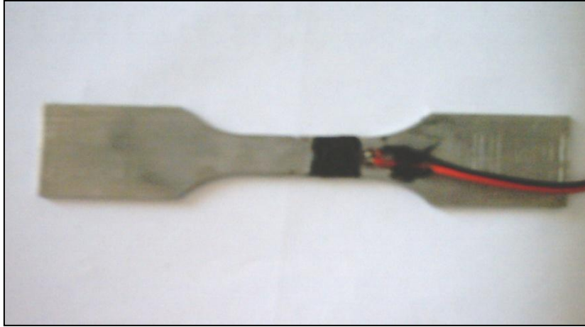
Fig. IV.7 Eprouvette lisse équipée d'une jauge de déformation.
