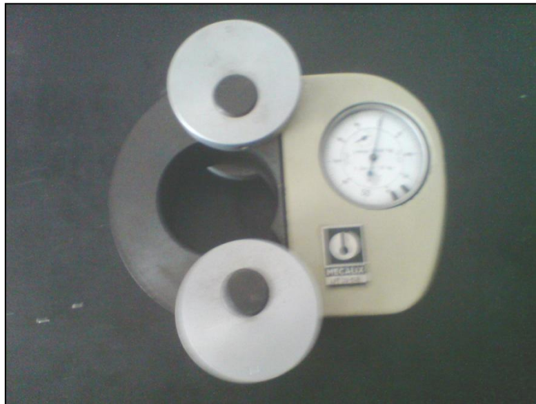
Fig. IV.4 Anneau dynamométrique de capacité 2 tonnes.
