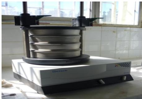
*Figure V.3 : Opération du tamisage de la bentonite*
