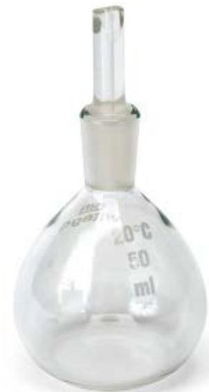
FIG. 34 : Pycnomètre.
