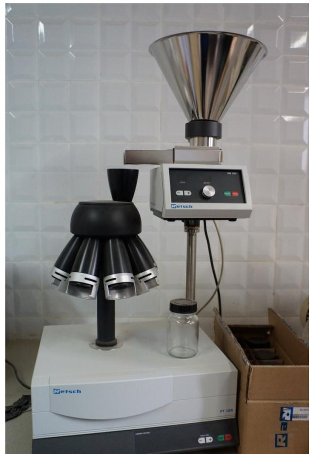
FIG. 31 : photo de l'échantillonneuse rotative.
