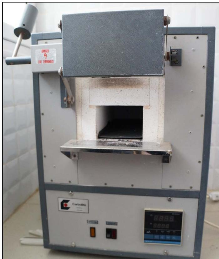
FIG. 40 : photo d'un four à moufle de laboratoire.
