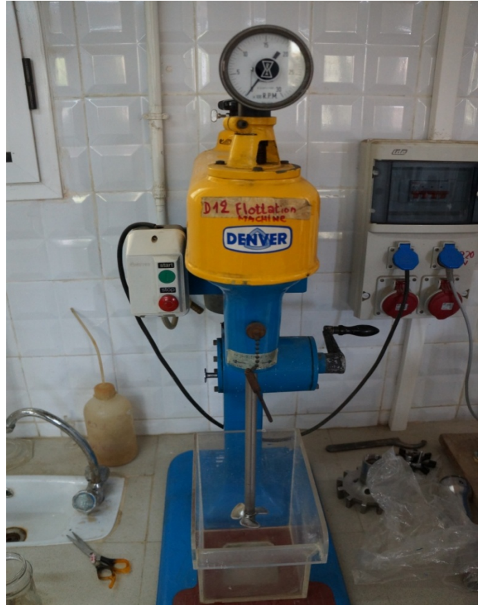
Figure V-22 : Photo d'une cellule de flottation DENVER.
