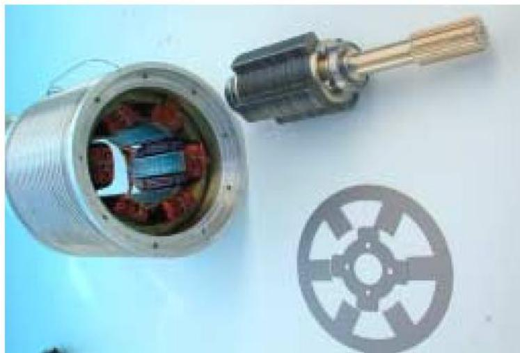
Fig. I.6 : Prototype de machine à réluctance variable double saillance de type 6/4 [34].
