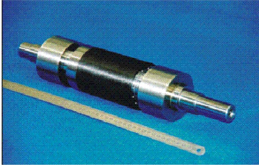
Fig. I.4 : Rotor d'une machine à aimants permanents surfaciques pour l'application à haute vitesse [34]
