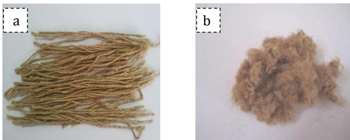
**Figure II.2.** Photos des fibres de jute utilisées: (a) avant découpage, (b) après découpage
