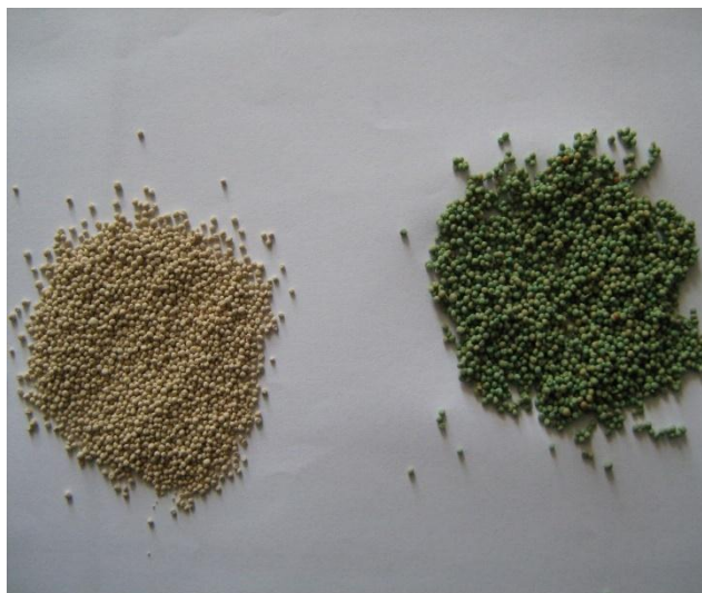
Figure V-2 billes Ca-alginate biomasse après séchage avant et après adsorption
