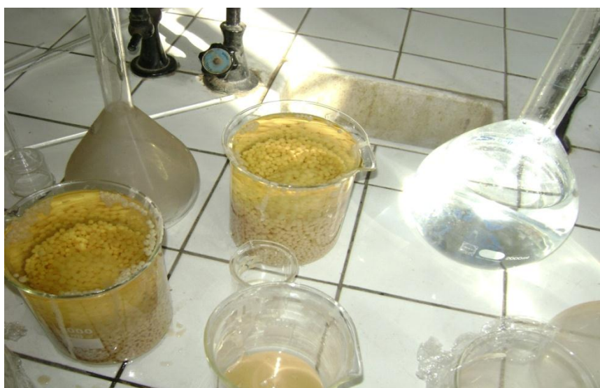
Figure V-1 Ca-alginate+biomasse dans la solution de \text{CaCl}_2 .
