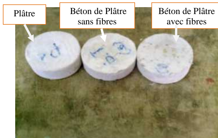
Figure III.43 : Etats de surface des échantillons immergés pendant deux semaines dans la solution MgSO_4 .
