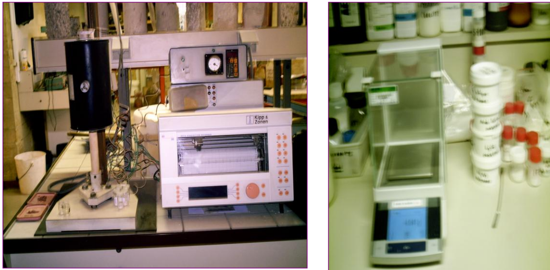
Figure II.2 : Dispositif utilisé de l'ATD et l'ATG couplée.
