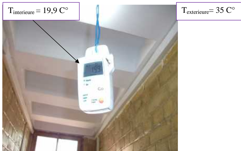
Figure I.34 : Détection de la température à l'intérieur et à l'extérieur du prototype avec une grande efficacité énergétique.
