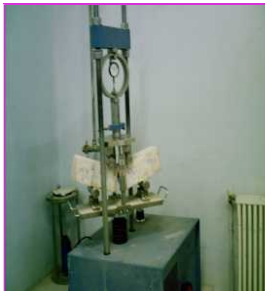
Figure III. 2 : Presse de l'essai de flexion.
