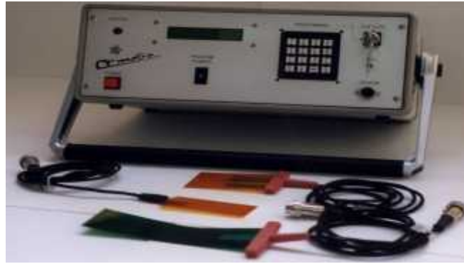
Figure IV.6 : Instrument de mesure des propriétés thermo-physiques «CT METRE» avec ses accessoires.
