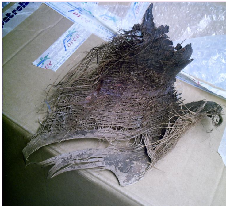
Figure II.9 : Plaques en treillis de fibres de surface du palmier dattier.
