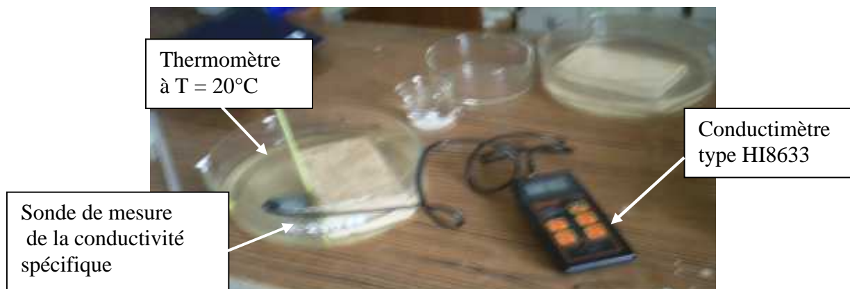
Figure III.50 : Essai de mesure de la conductivité spécifique sur l'échantillon béton de plâtre (sans fibres).
