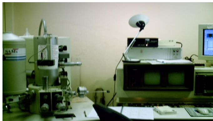
Figure II.24 : Microscope électronique à balayage Hitachi 800 équipé d'une microanalyse.
