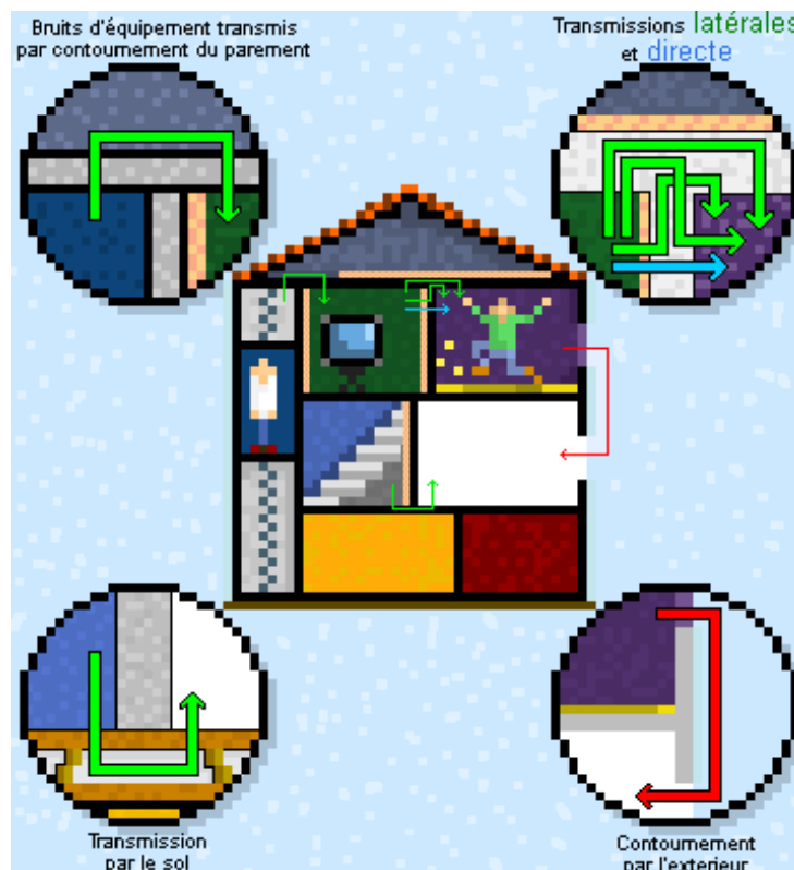
Figure V.7 : Les différents types de transmissions du bruit.
