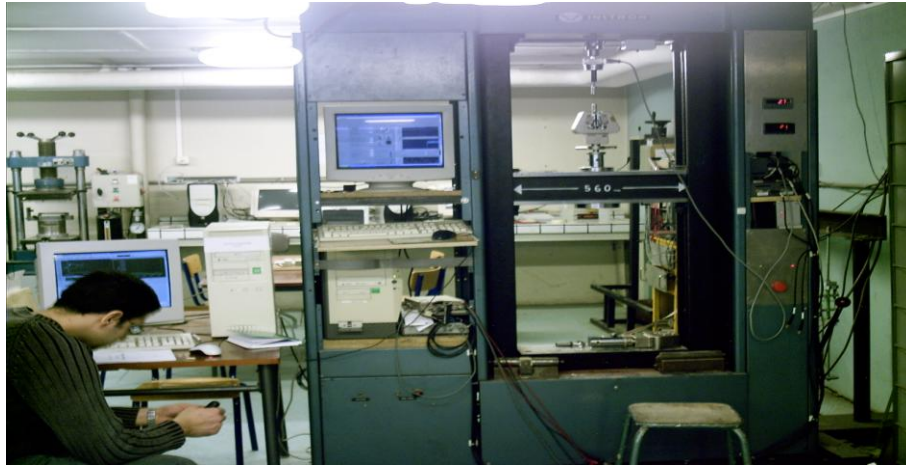
Figure II. 17: Machine universelle d'essai de traction des fibres de type INSTRON au sein du laboratoire LGCIE à L' INSA de Lyon.
