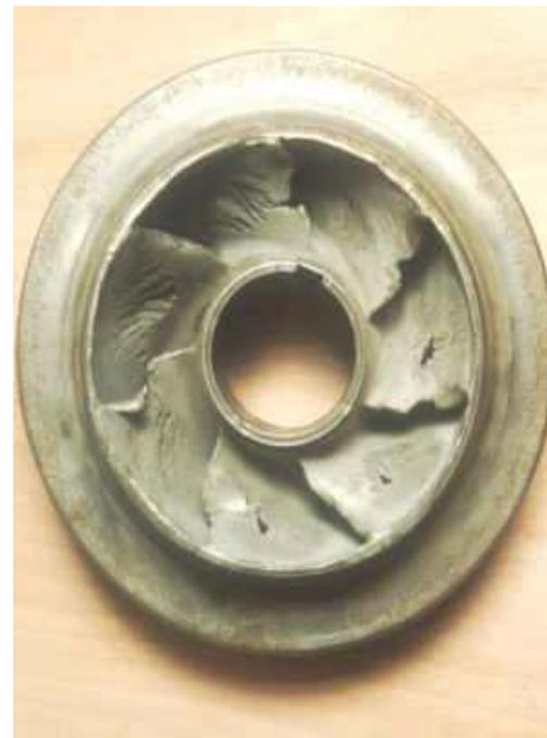
Figure 2.5 : Le phénomène de cavitation sur des aubes d'une pompe centrifuge. [6]
