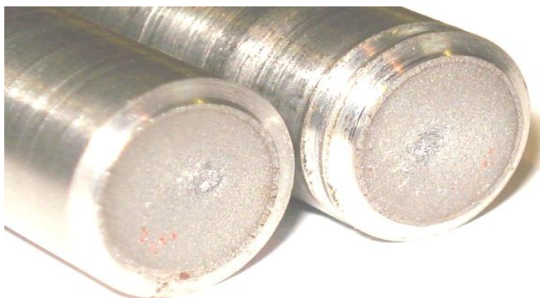
Photo IV.1: Rupture de l'éprouvette pour X = 1,5 mm
