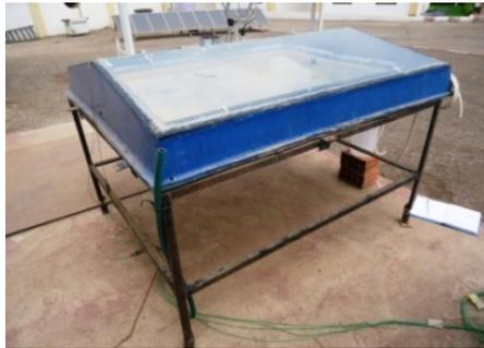
Figure V.1 a : Distillateur solaire
