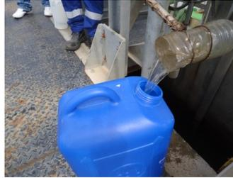
**Figure V.3 :** 1<sup>er</sup> Point de prélèvement de l'eau usée brute.
