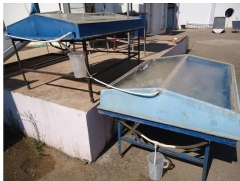
**Figure V.2 :** Banc d'essais de l'épuration par bi-distillation solaire.
