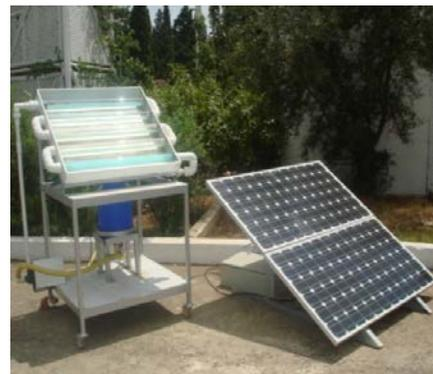
**Figure VI.5 :** Photoréacteur tubulaire de 30 l [139].
