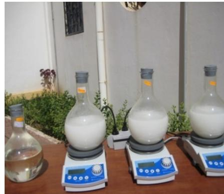
*Figure VI.3*: Banc d'essais de photocatalyse solaire.
