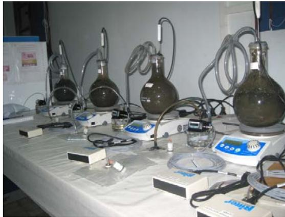
**Figure IV.9 :** Banc d'essais de méthanisation des boues résiduaires.
