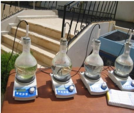
*Figure VI.2* : Banc d'essais de photolyse solaire.
