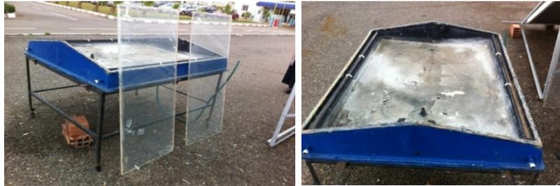
**Figure VII.1 :** Distillateur solaire transformé en lit de séchage à l'air libre des boues résiduaires.
