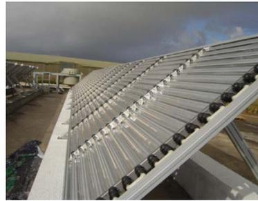
**Figure III.20 :** Photoreacteur plats en escaliers [89]. **Figure III.21 :** Photoreacteur tubulaire à CPC [89].
