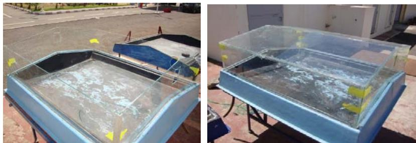
**Figure VII. 2 :** Distillateur solaire transformé en serre de séchage des boues résiduaires.
