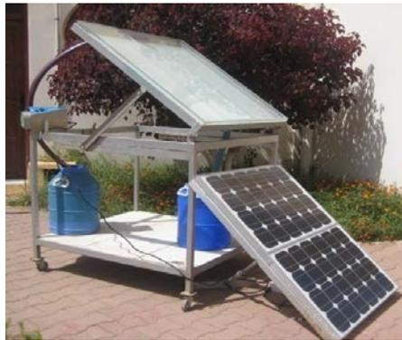
**Figure VI.4 :** Photoréacteur parallélépipède de 50 l [138].
