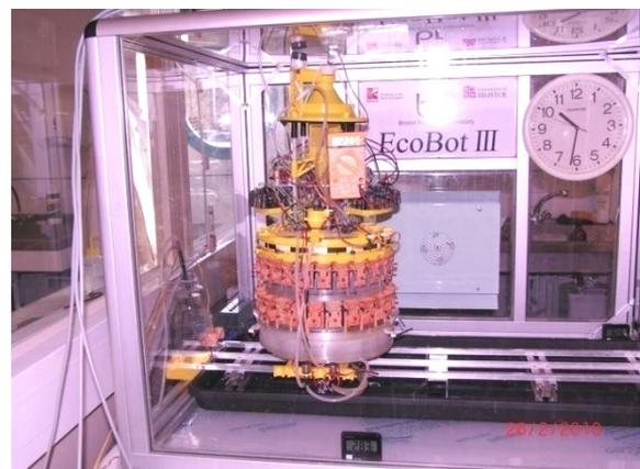
**Figure III.10 :** EcoBot III, un robot fonctionnant par piles à combustible microbiennes [67].
