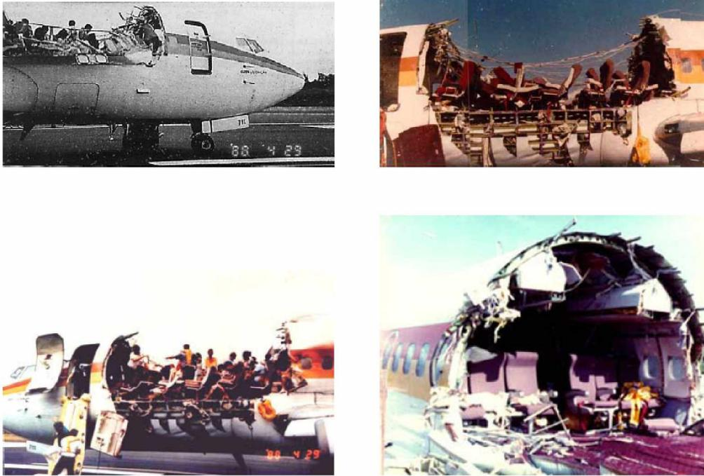
*Fig. A. Accident du Boeing 737 d'Aloha Airlines (avril 1988)*
