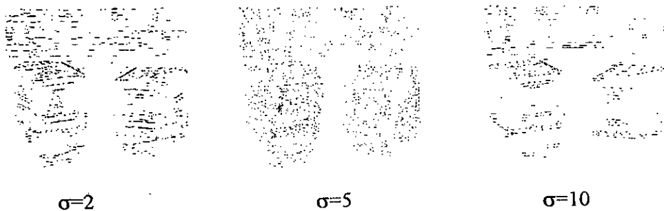
Figure II.24 : Localisation des contours pour différentes valeurs de \sigma , avec \theta=90^\circ , \rho_1=20 , \rho_2=20.2 , \rho_3=20.5 , \rho_4=20.7 , \rho_5=21 .
