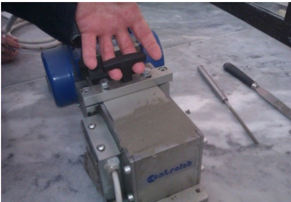
Figure III.3: Essai sur la consistance du mortier (Maniabilimètre)
