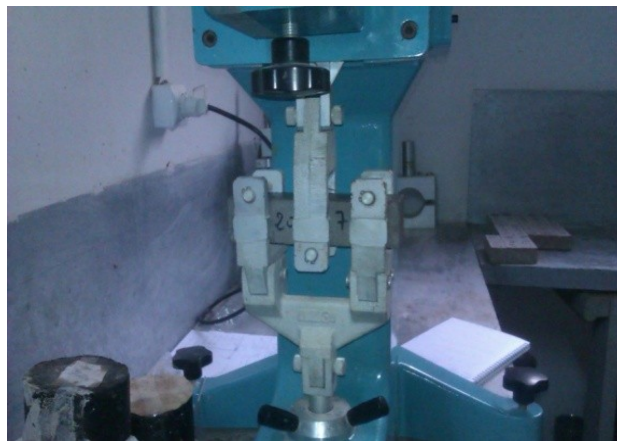
Figure IV.7: Teste d'adhérence des mortiers
