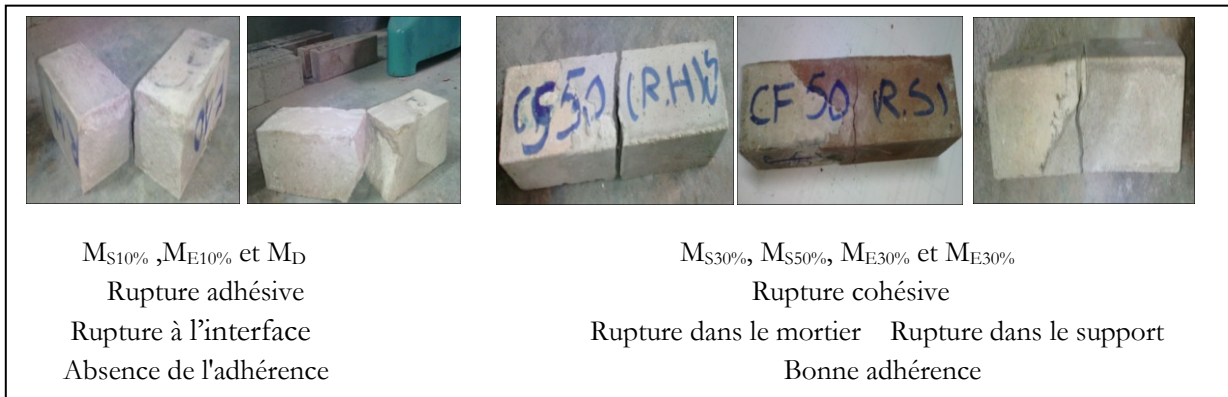
Figure IV.48: Mode de rupture des mortiers
