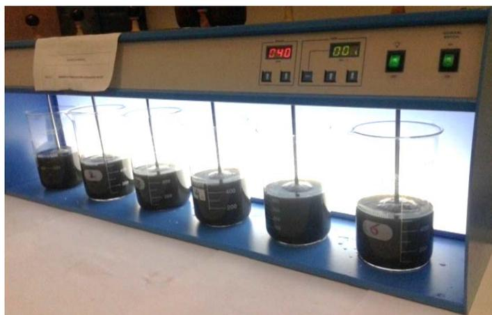
**Figure I.2 :** Photo illustrant l'essai de coagulation sur jar-test.
