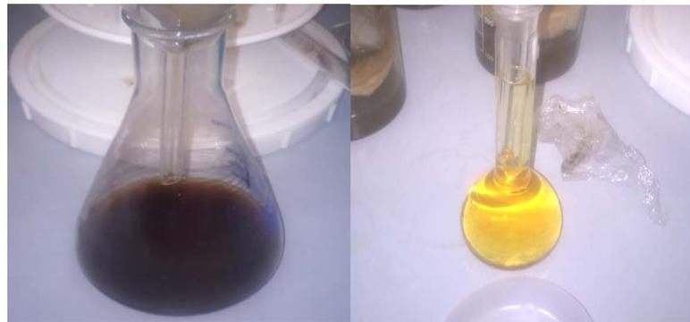
**Figure II.12** : Couleur des lixiviats avant et après traitement.
