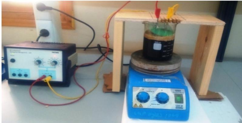
**Figure I. 3:** Dispositif expérimental d'électrocoagulation utilisé.
