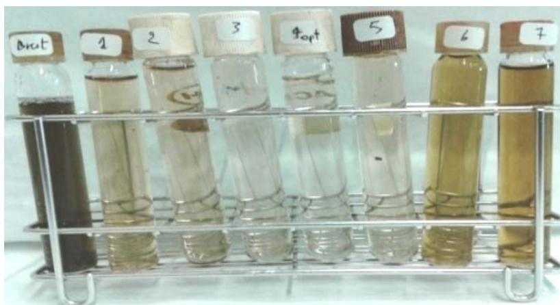
**Figure II.3** : Évolution de la couleur du lixiviat après traitement par  $\text{FeCl}_3$ .
