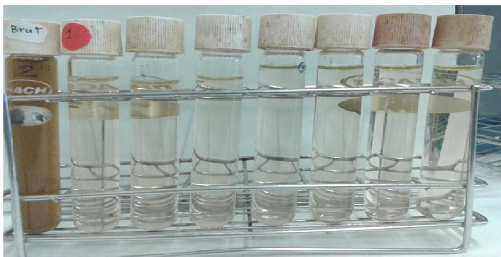
**Figure II.6** : Évolution de la couleur de lixiviat après traitement par FeCl<sub>3</sub>.
