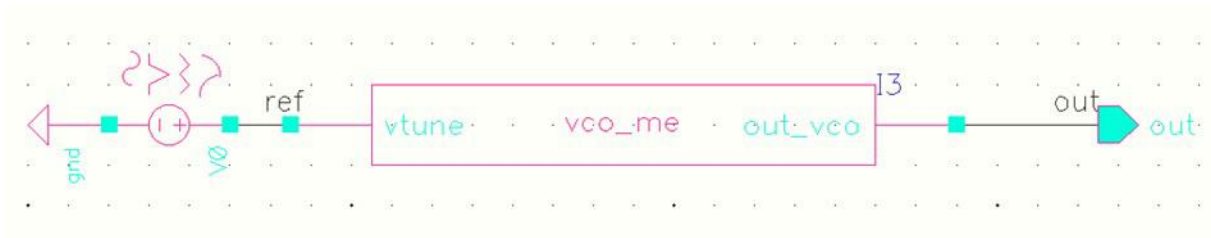
Figure 2. 10 : Setup de simulation du VCO
