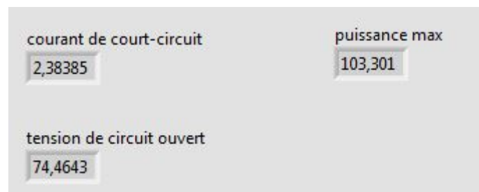
Figure 51 Paramètres d'un module photovoltaïque.
